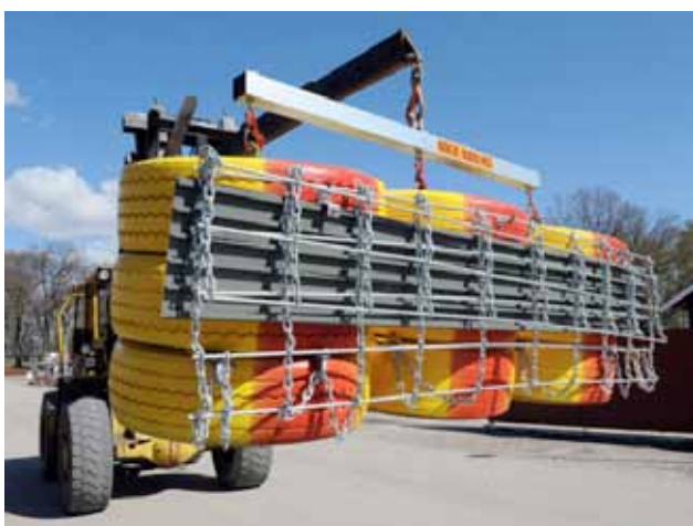
701 1712 Lyftok, CE-märkt Lyftok måste användas när bufferten flyttas med monterat skyltstativ. OBS! Lyftoket får ej sitta kvar på bufferten när den är utställd på vägen.
