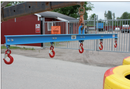
701 1712 Lyftok, CE-märkt Lyftok måste användas när bufferten flyttas med monterat skyltstativ.
